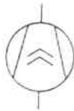
سمبل کمپرسور اسکرو یا پیچ Symbol of screw compressor
